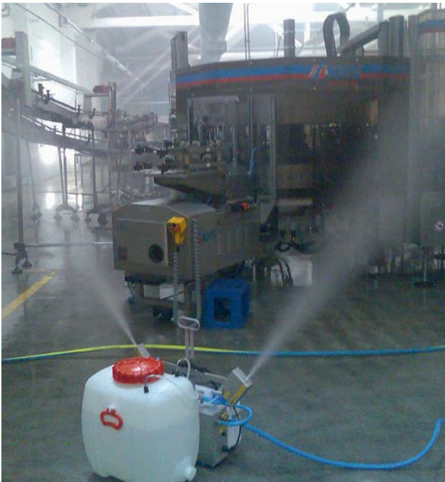
Mit einem speziellen Vernebelungsgerät wird der Wirkstoff in feinsten Tröpfchen in die Raumluft eingebracht, so dass alle Oberflächen benetzt werden.
