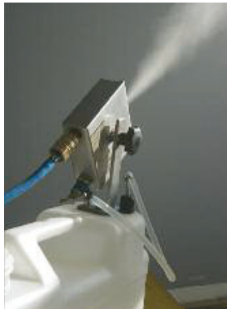
Mittels Kaltvernebelung gelangt eine Polymerlösung bis in jede Ritze und bekämpft Schimmelpilze und Sporen rein physikalisch.
