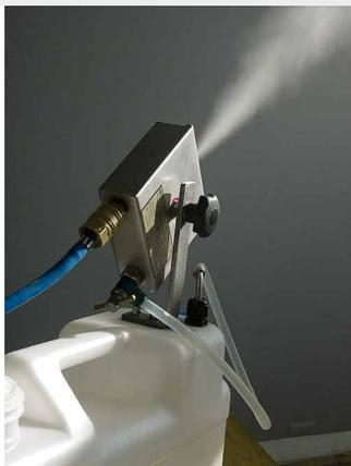
wird der ganze Raum durch eine sehr feine Kaltvernebelung von Schimmel und Schimmelsporen befreit. So erreicht der Wirkstoff jeden Winkel und desinfiziert selbst die Raumluft. Dieses Verfahren soll einen langfristigen Schutz gegen Neubefall garantieren.
