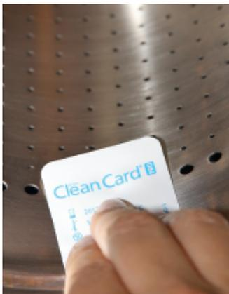
Der Clean-Card-PRO-Test kontrolliert die ordnungsgemäße Reinigung in Sekundenschnelle.
