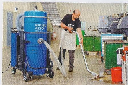
Attix 145 arbeitet mit einer Luftmenge von 5.250 l/min und erbringt eine Motorleistung von 2,2 kW, während das Modell 155 4 kW bei einer Luftfördermenge von 8.600 l/min leistet. [www.nilfisk-alto.com](http://www.nilfisk-alto.com)
