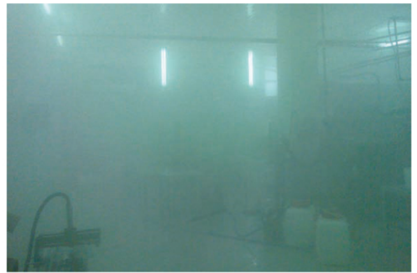
Das Bild zeigt die Entkeimung per Kaltvernebelung in einer Speisefabrik. Bilder: Vallovapor
