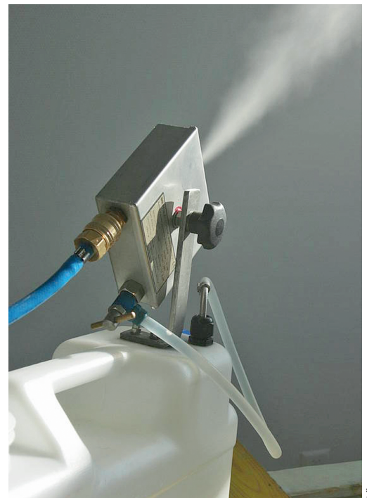
Das Biozid wird mit einem speziellen Vernebelungsgerät in feinsten Tröpfchen in die Raumluft eingebracht – so fein, dass keine Nässe oder Feuchtigkeit entsteht, sondern ein feiner, stehender Wirkstoffnebel.
