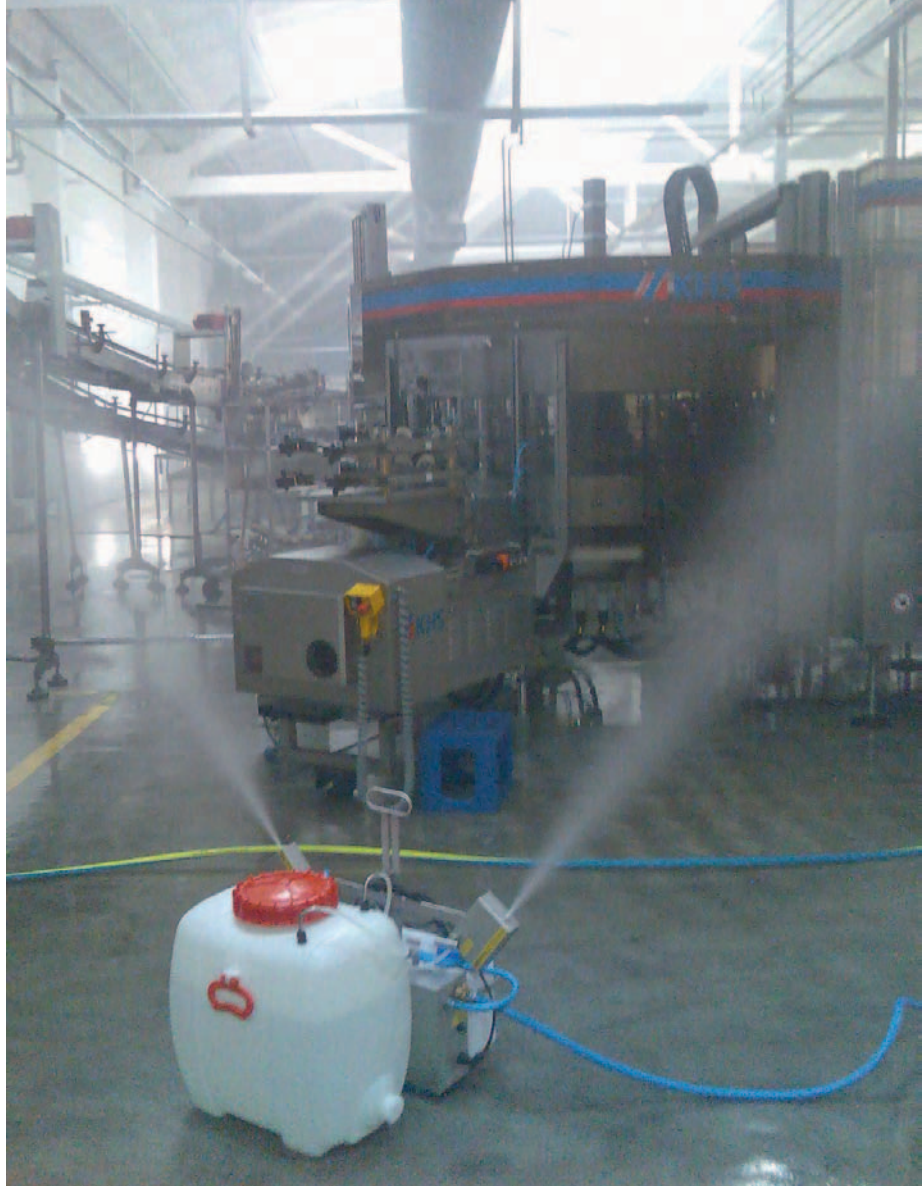
Durch spezielle Vernebelungsgeräte wird das Biozid als Kaltnebel in die Raumluft eingebracht. Bild: Vallovapor
