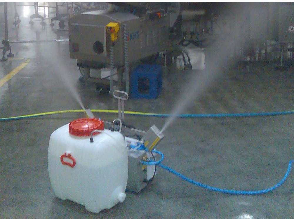
Abb. 1: Anwendung der Kaltvernebelung in einer Käserei.
