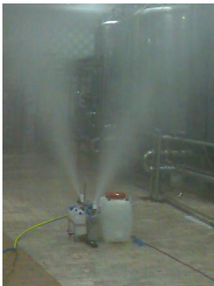
Abb. 4: Anwendung der Kaltvernebelung in der Getränkeindustrie.
