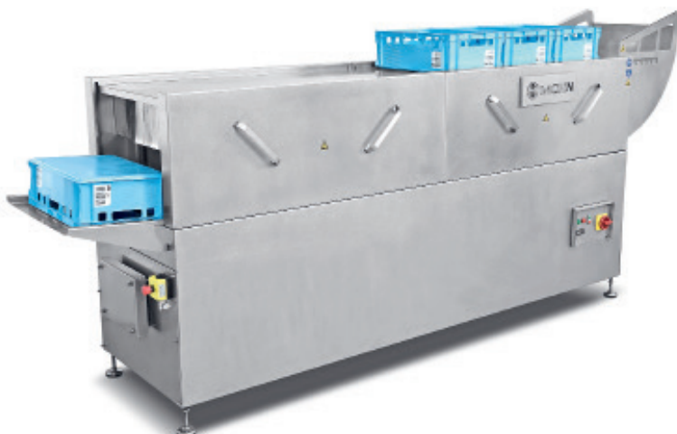
Ein besonderer Vorteil: Die integrierte Kistenwenderfunktion übernimmt die Drehung automatisch. Das spart Personal und reduziert die Laufwege.
