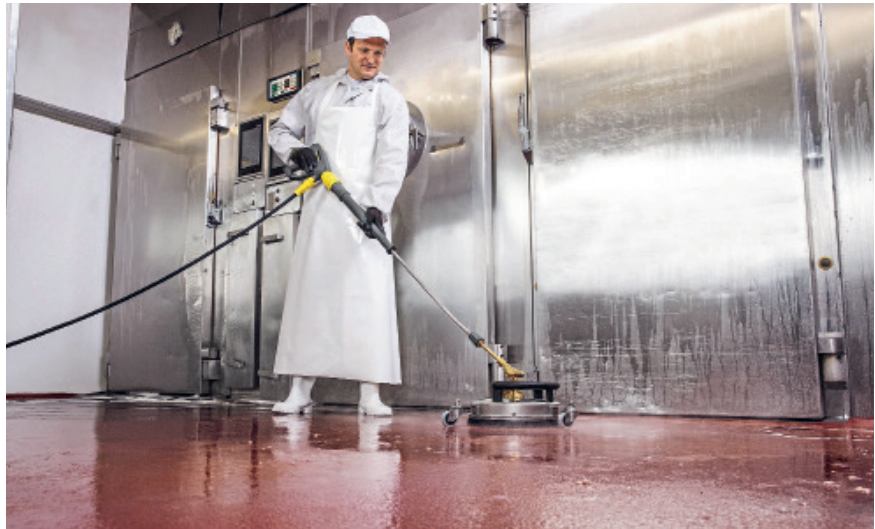
Die Bodenreinigung in Fleischereien erfolgt effektiv mit einem Hochdruckreiniger. Mit dem Einsatz einer oszillierenden Einscheibenmaschine bekommt man die Böden sauber und trittsicher.
